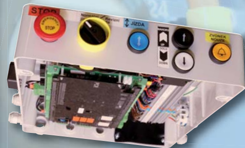
Revízna jazda nad kabínou Umožňuje ovládanie kabíny pri revíziách, servise zo strechy kabíny.
